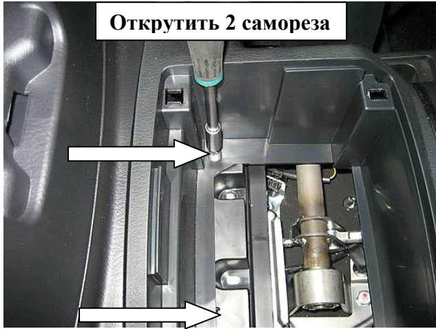
Открутить 2 самореза, снять заднюю консоль
