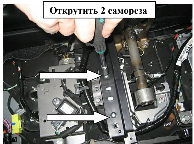
Снять верхнюю панель
