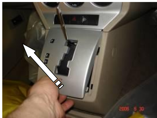
Снять верхнюю крышку
