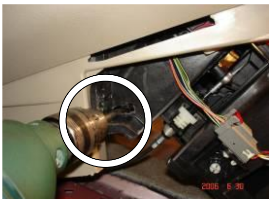
Удалить мешающий установке замка пластик
