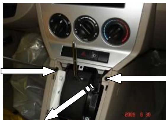
Открутить 2 самореза, снять консоль
