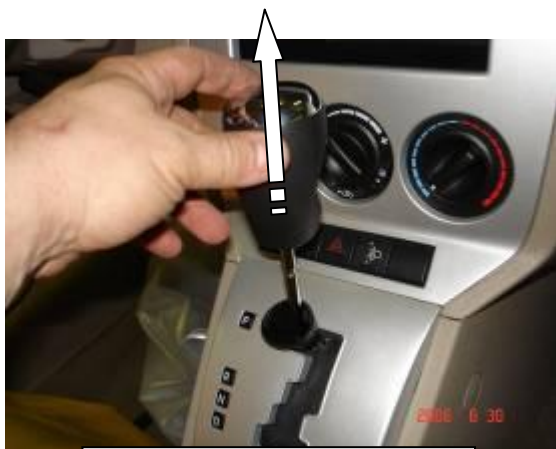
Снять рукоятку рычага переключения передач
